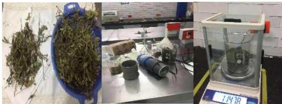
Figura 1. Proceso de preparación del material biológico (secado, molienda y pesaje)
