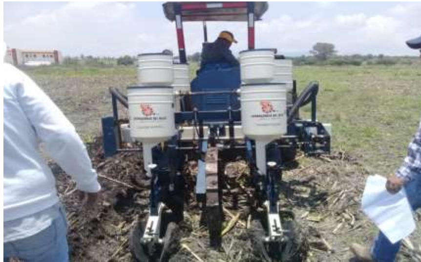
Figura 1. Sembradora de precisión con dos cuerpos (Sembradoras del Bajío) neumática modelo SD-2011-DSCF-2
