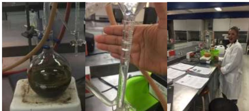
Figura 2. Metodología para la extracción de aceites esenciales por hidrodestilación
