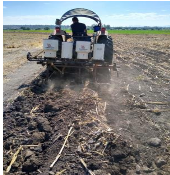
Figura 2. Sembradora de precisión neumática modelo SD-2011-DSCF-2.
